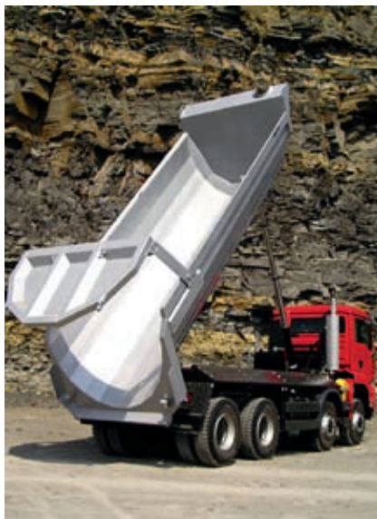
Die Beschichtung wird auch für solche stark beanspruchten Ladeflächen eingesetzt
